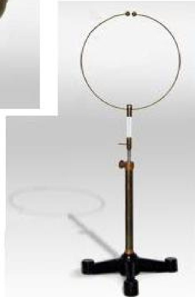
Oscillatore e risuonatore di Hertz
