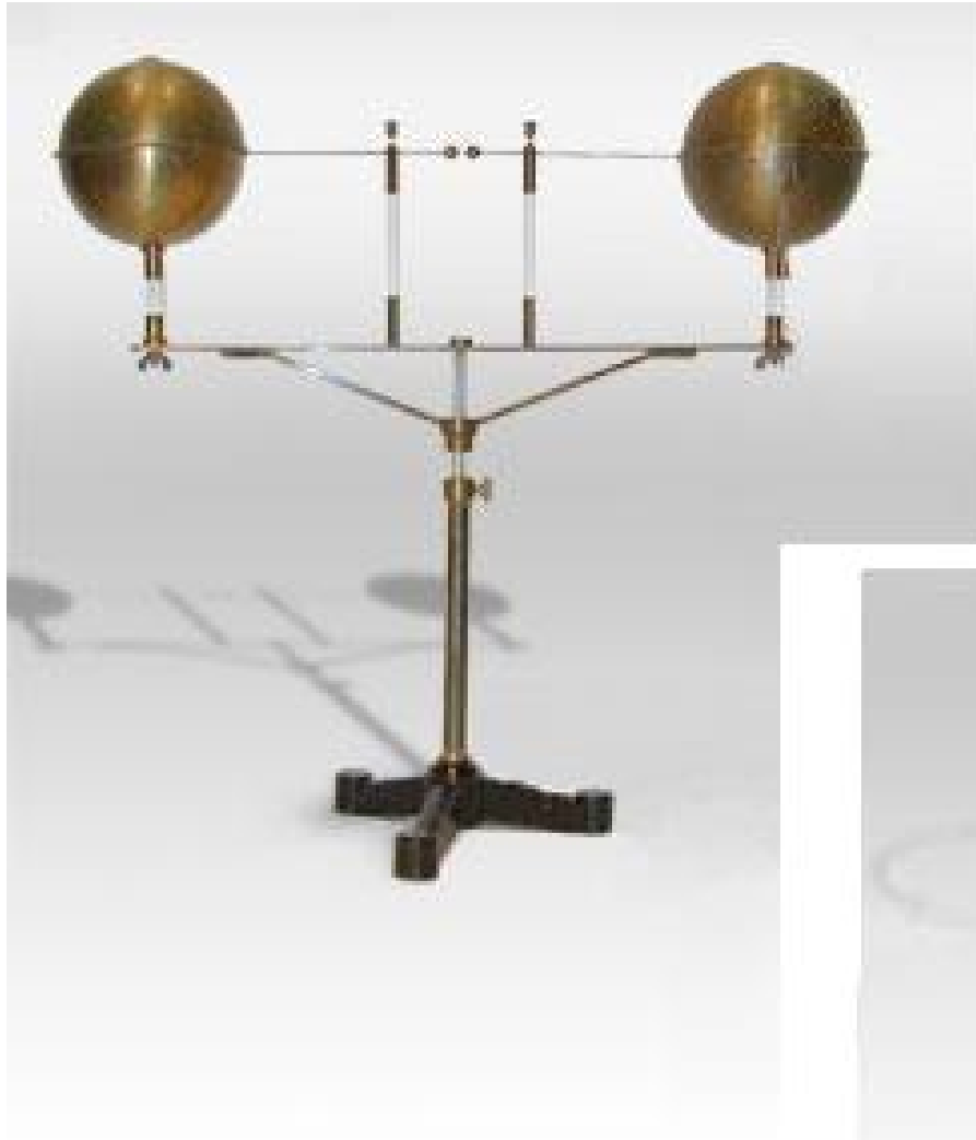
Oscillatore e risuonatore di Hertz
